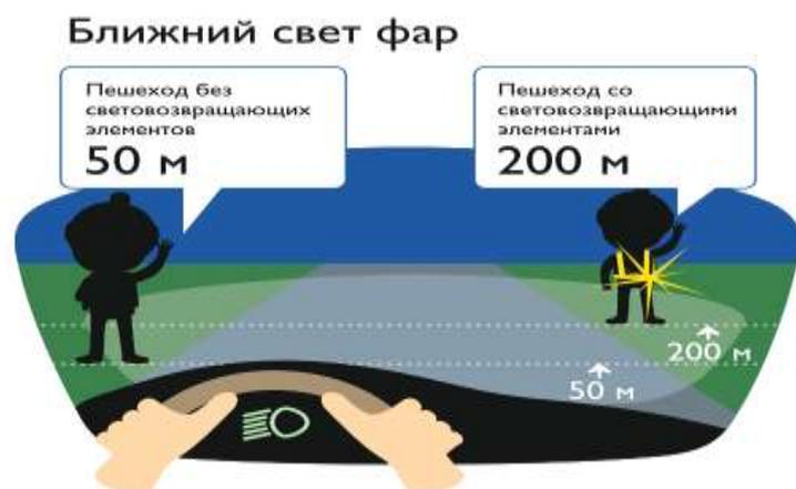
При движении с ближним светом фар водитель автомобиля способен увидеть пешехода на дороге на расстоянии 25-50 метров. Если пешеход применяет световозвращатель, то это расстояние увеличивается до 150-200 метров. А при движении автомобиля с дальним светом фар дистанция, на которой пешеход становится виден, с применением световозвращателей увеличивается со 100 метров до 350 метров. Это даёт водителю 15-25 секунд для принятия решения.
